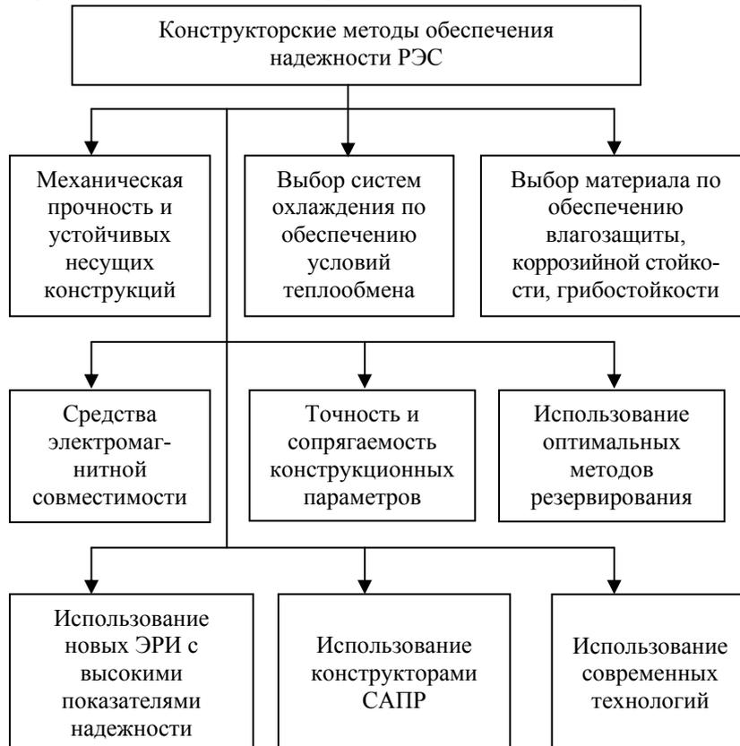
Рис. 6.17. Методы создания высоконадежных РЭС
