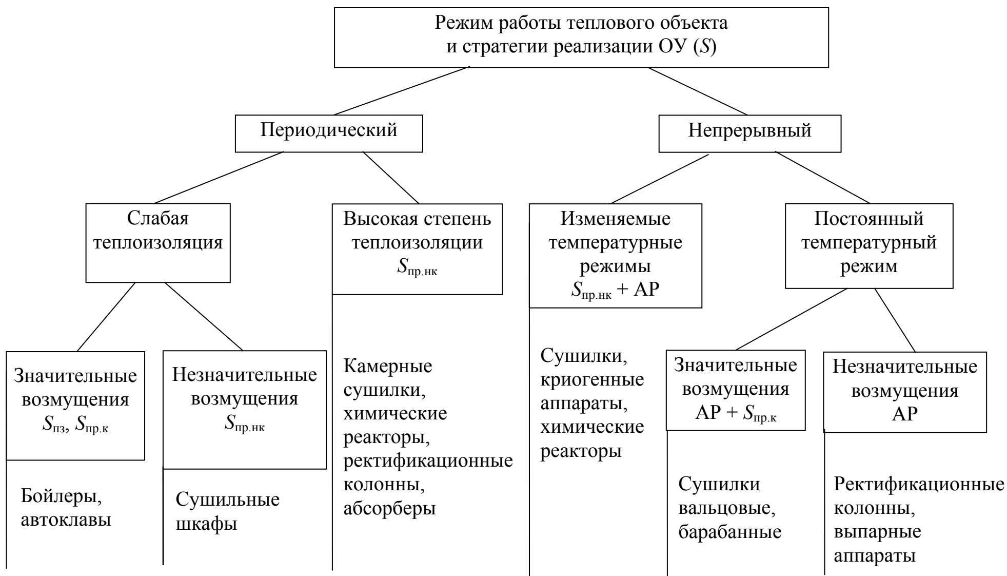
Рис. 1.2 Классификация тепловых объектов по режимам работы, определяющим стратегии реализации ОУ ( S_{пр.к} , S_{пр.нк} – программные стратегии корректируемая и некорректируемая соответственно; S_{пз} – позиционная стратегия; AP – автоматический регулятор)
