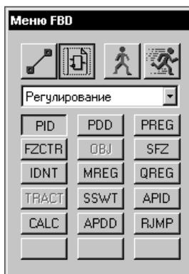
Здесь сначала указывается функциональный раздел (в данном случае «Регулирование»), а затем в нем выбирается требуемая функция (в данном случае PID).
