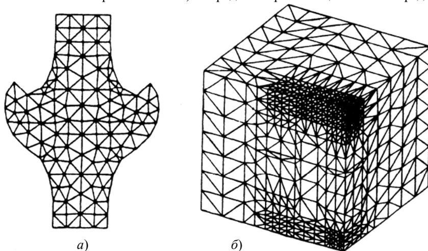
Рис. 1 Примеры разбиения расчетных областей в двумерных (2D) и трехмерных (3D) задачах
