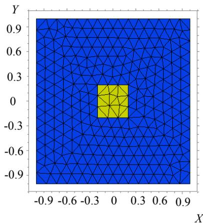
**Рис. 13** Сетка конечных элементов
