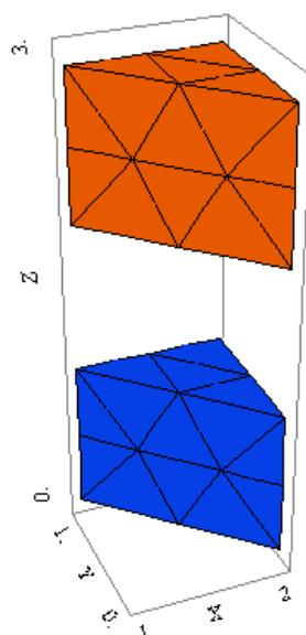
Рис. 9 Расчетная область, в которой посредством инструкции *VOID* исключен один слой
