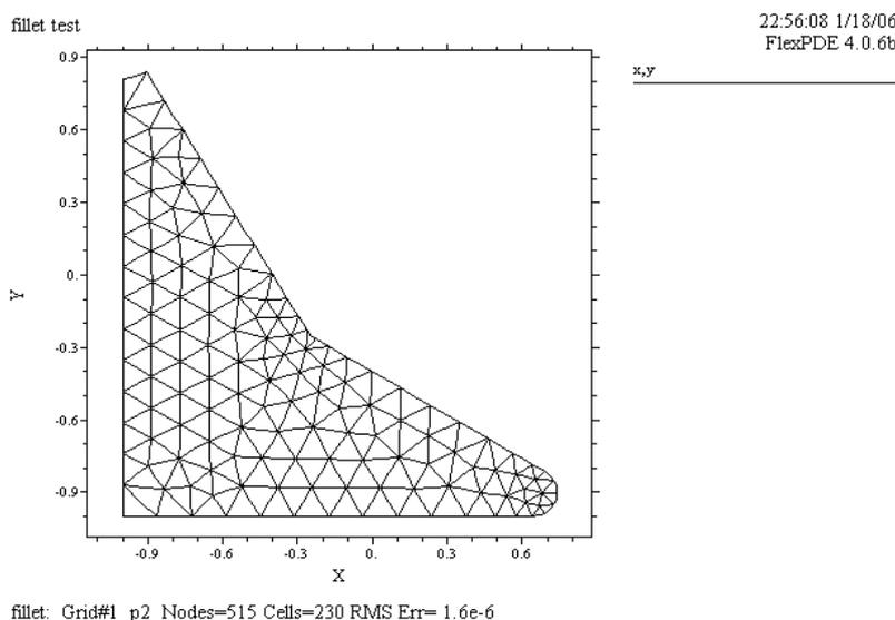
**Рис. 7** Расчетная область, созданная с использованием инструкций *FILLETS* и *BEVELS*
