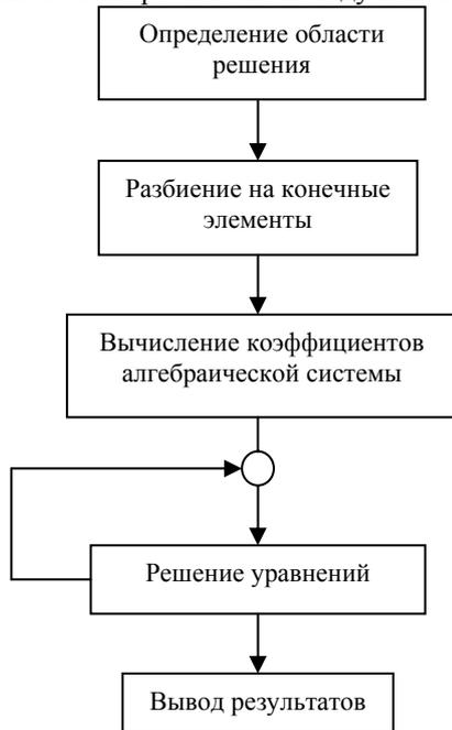
Рис. 2 Схема организации расчета по методу конечных элементов
