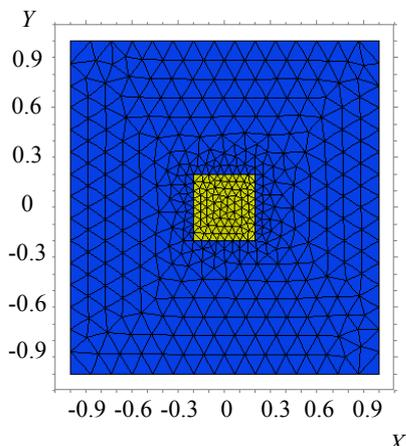
**Рис. 14** Сетка конечных элементов
