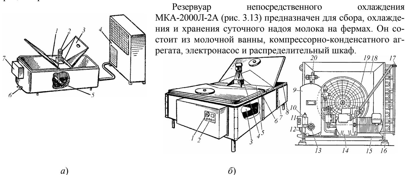
**Рис. 3.13 Резервуар непосредственного охлаждения молока МКА-2000Л-2А:**
