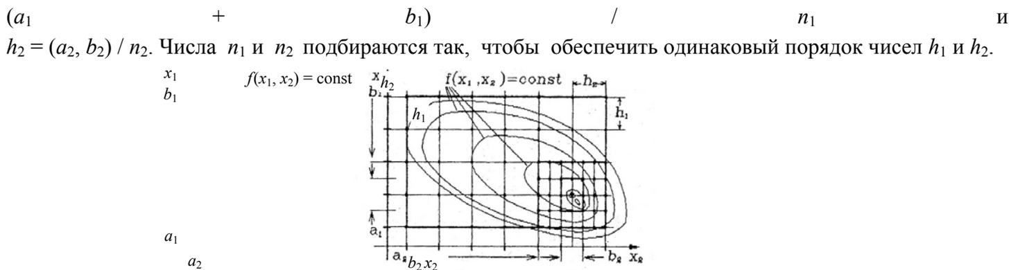
**Рис. 29** Графическое изображение метода сеток
