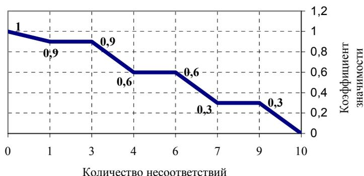
**Рис. 3 График зависимостей коэффициентов весомости от количества выявленных несоответствий**
