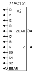
Рис. 3.6 Примеры микросхем мультиплексора и демультиплексора
