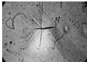
**Рис. 4.3. Канал Розе второго рода в цинке.**
