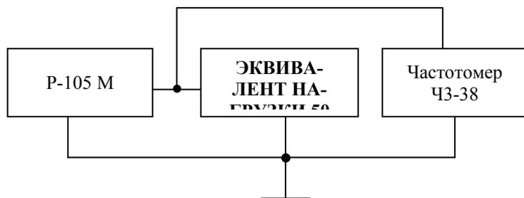
**Рис. 4** Схема подключения радиостанции для измерения погрешности установки частоты
