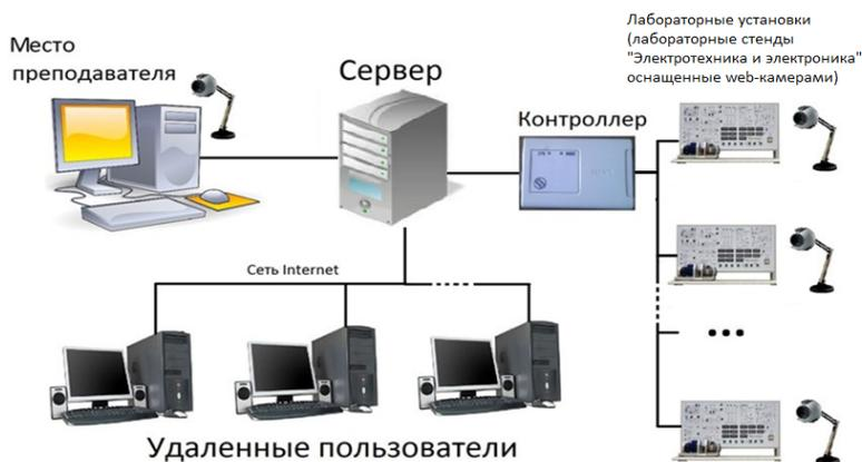
Рис. 1. Структурная схема лабораторного комплекса
