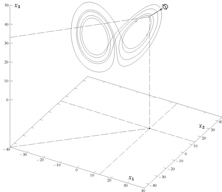
**Рис. 2.** Дуга траектории системы Лоренца, построенная на отрезке времени  $[0; 6,827]$ , для начальной точки с координатами  $(13,41265629; 13,46430003; 33,46156416)$ . Стрелкой отмечено возвращение в  $\epsilon$ -окрестность ( $\epsilon = 0,11$ )
