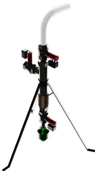
Рис. 1. Экспериментальная установка определения влияния вакуумных технологий на процессы мойки пищевых емкостей
