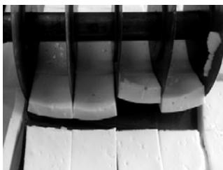
**Рис. 3.32. Адгезионное разрушение при формировании комбинированных корпусов методом размазки и резки**
