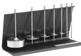
**Рис. 1.4. Набор стандартных роторов для различной вязкости исследуемой среды и требуемого диапазона скоростей деформации**
