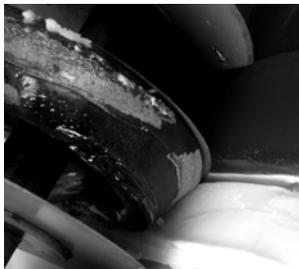
**Рис. 3.33. Смешанное разрушение адгезионного соединения при формировании комбинированных корпусов методом размазки и резки**
