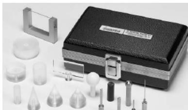
**Рис. 1.6. Набор тестовых приспособлений для различных видов продукции**
